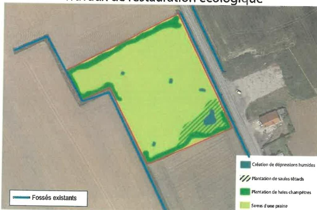
Figure 51. Cartographie de la localisation des aménagements à réaliser sur le site de compensation 2
